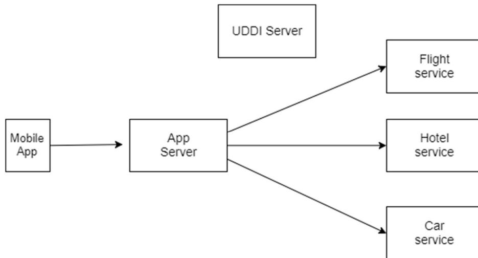
O sistema utiliza uma concretização do protocolo 2PC. Cada serviço oferece localmente as propriedades ACID e está a ser utilizado um controlo de concorrência pessimista. O excerto de código seguinte mostra o que é executado no servidor aplicacional quando o cliente da aplicação móvel pede para comprar o pacote.
